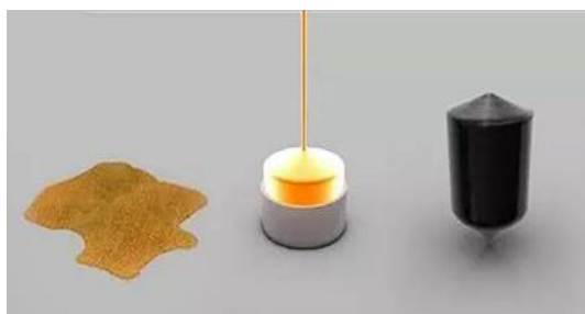
图 1：硅净化熔炼得到单晶硅锭
