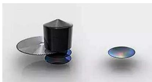
图 2：硅锭切割为硅片即晶圆
